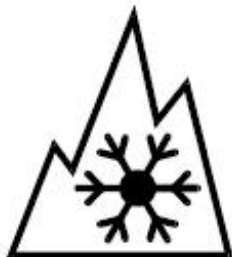
Рисунок 4.3 - Маркировка, наносимая на зимнюю шину
